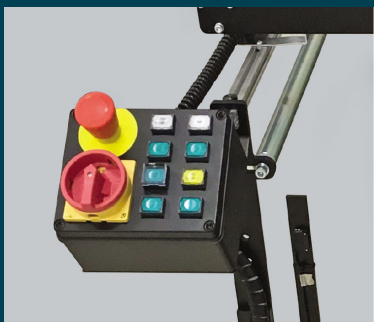
Nouzová stop tlačítka synchronizovaná s řezačkou.
